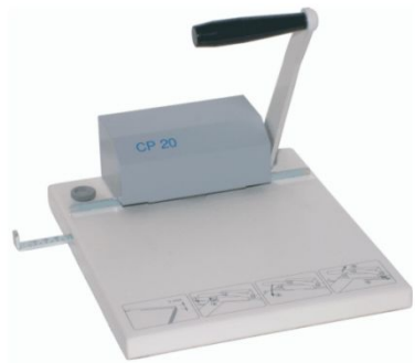
CP 20 - CYKLOS - KALENDERHAAKVORM UITKAPMES Voor het uitkappen van een halve cirkel om een kalenderhaak te kunnen plaatsen bij het inbinden met "double loop" metalen spiralen in voor-geperforeerde bladen. Uitkap capaciteit : 3mm. Kantlijn capaciteit : voor bladen van 250 tot 540mm breed.
